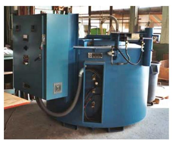
Si se vacía el crisol y se le desconecta el suministro de entrada, utilizará 6.000.000 BTU solo para volver a llenarse. La velocidad de fusión baja mucho con el crisol vacío con respecto al crisol lleno de metal. Podría llevar seis horas para recalentar y fundir el metal hasta volver a tener la cuba llena. Para la primera mitad del tazón, iusará 2.000 BTU por libra de fundal
